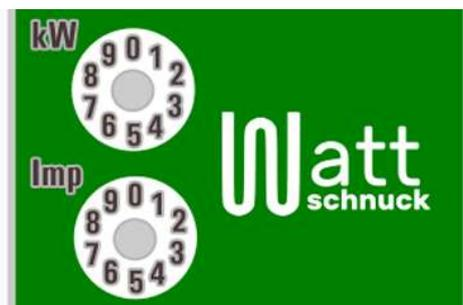
Stellen Sie die Drehkodierschalter entsprechend ihrer Anwendung ein. Für den Relais-Betrieb werden die 24V-Ausgänge verwendet. Die kW – Einstellung entspricht der Einschaltsschwelle für jede Stufe. Verwenden Sie die stufenlose Regelung mit 0-10V Ausgang, brauchen Sie nichts einstellen bzw. lassen Sie einfach bei Einstellungen auf „0“. Wattschnuck regelt automatisch nach. Bei der Verwendung von Energiezählern müssen Sie in jedem Fall die Impulse /kWh angeben.
